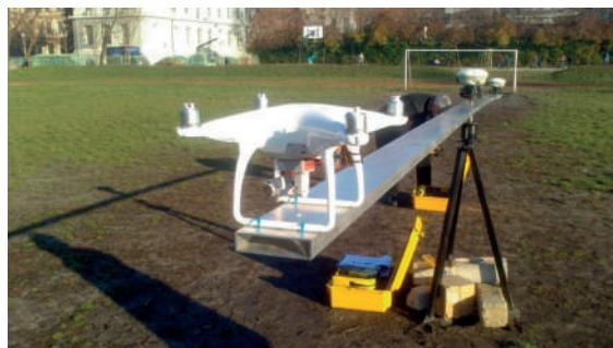
Slika 2.3: Ispitivanje točnosti GNSS senzora na UAV DJI Phantom 4 (foto: D. Blaženka)
