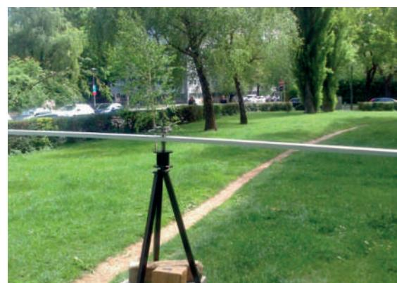
Slika 2.1: Platforma za ispitivanje navigacijske točnosti besposadne letjelice (foto: D. Blaženka)
